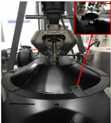
图 16 加载装置 Fig. 16 Loading device
